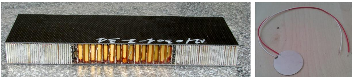
Figure 1: A gauche: matériau sandwich représentatif du domaine aéronautique et à droite disque piézoélectrique.
