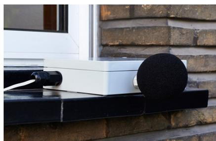
L'alimentation du capteur augmentera votre facture électrique d'environ "1 euro" par mois. Le capteur stocke le niveau sonore de la rue et envoie, via Internet les données sur un serveur.
